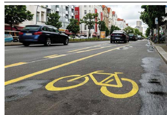
Figura 11 | Un carril ampliado para ciclistas en Berlín ofrece suficiente espacio para que los ciclistas se distancien físicamente, al tiempo que reduce el ancho de los carriles para automóviles
