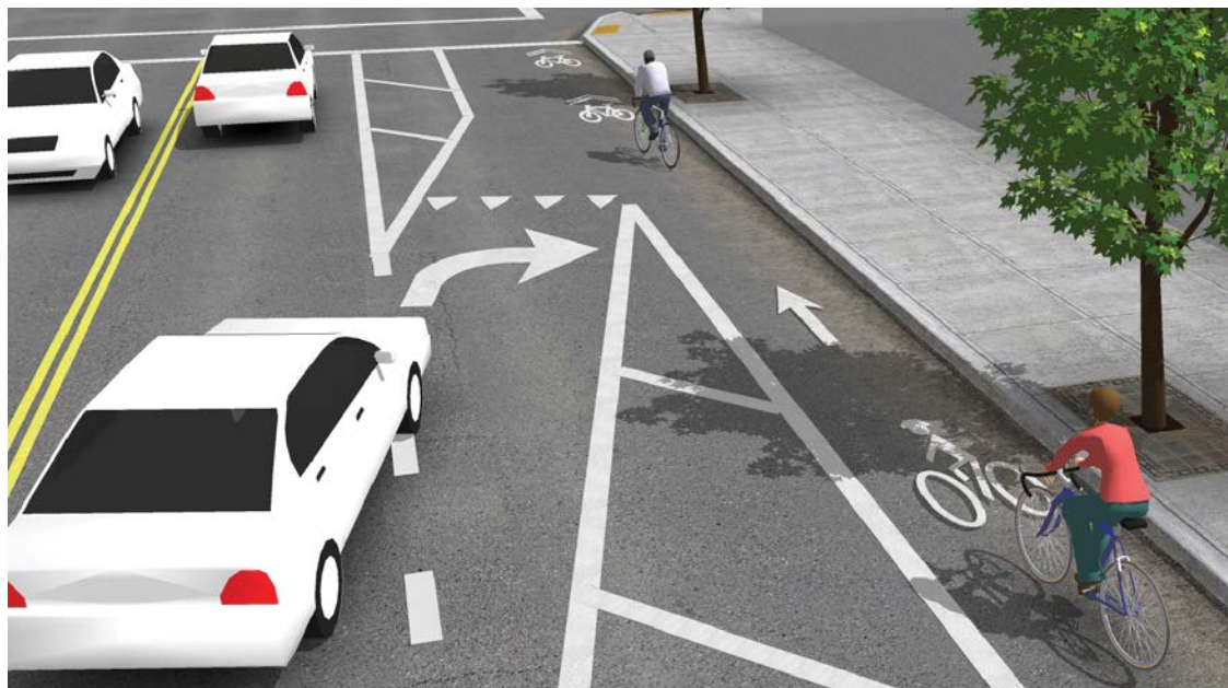
Figura 29 | El diseño de cambio lateral hace que los conductores que giran sean conscientes de que deben ceder el paso a los ciclistas que van en línea recta
