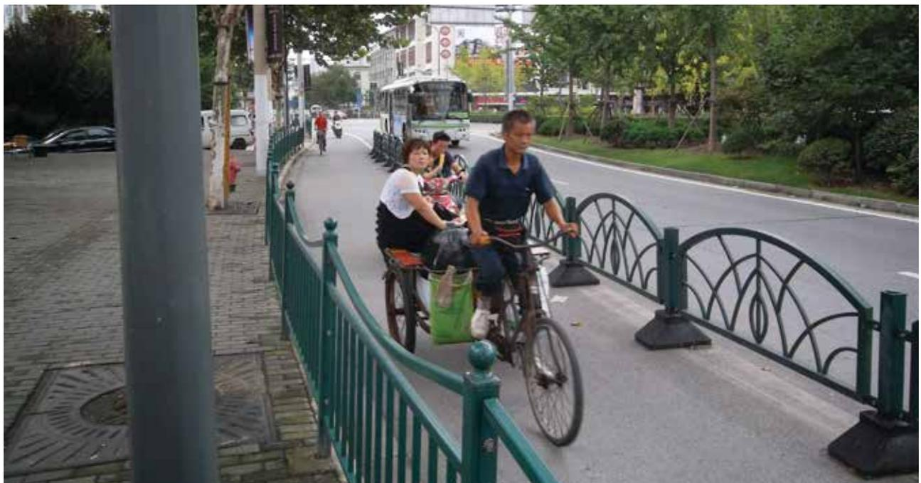
Un carril para bicicleta de un solo sentido en Ciudad de México protege a los ciclistas por medio de barreras físicas y señalización donde desaparecen las barreras (puntos de acceso de automóviles).
