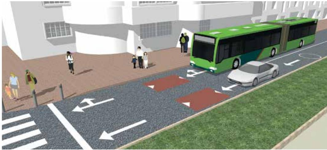
Los reductores de velocidad tipo cojín permiten el paso de los vehículos de eje ancho como los autobuses sin incomodar a los pasajeros.
