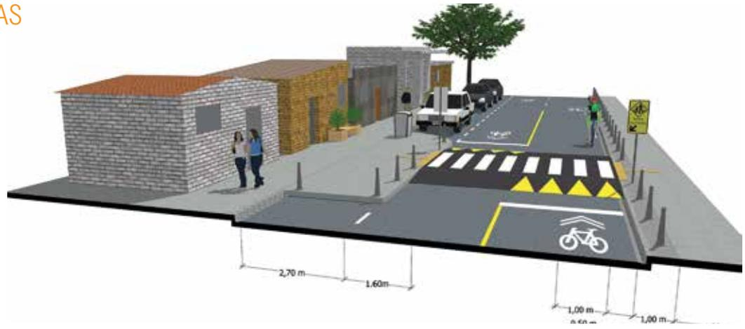
Calle de uso compartido con bicicletas, con diseño tipo bulvar, señalización vial y medidas de tránsito calmado.
