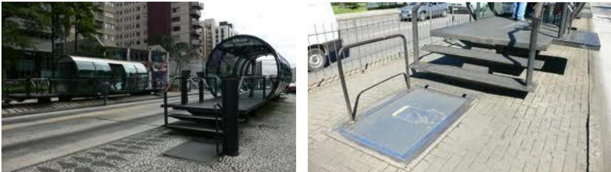
**Figura 28: Estación del sistema BRT de Curitiba, Brasil con acceso para discapacitados**
